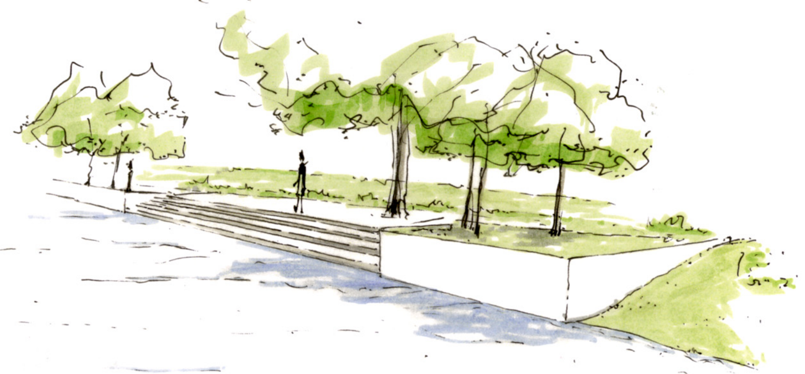
Ansicht auf Sitzstufen mit seitlichen Bastionen aus Gabionen
